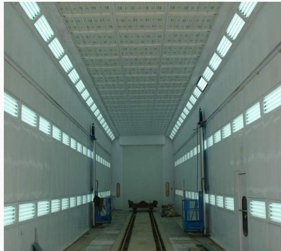
Специфика работы окрасочной камеры для вагонов предполагает установку фильтров воздуха, причем с возможностью оперативного демонтажа/монтажа их фильтрующих элементов. Покрасочно-сушильные камеры для вагонов оборудуются фильтрами так, чтобы очищался, как приточный, так и удаляемый из нее воздух. Для этого в системах очистки окрасочных камер для вагонов используется многоступенчатая очистка.
